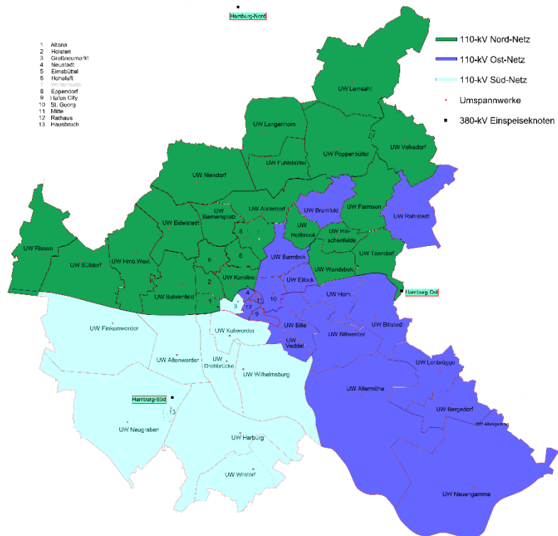
Abbildung 2: Versorgungsbereiche der HS/MS-Umspannwerke
