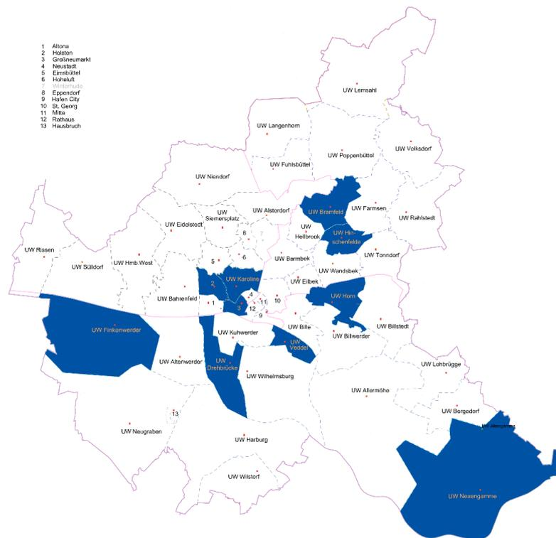
Abbildung 5: Engpässe im Mittelspannungsnetz 2034 bis 2045
