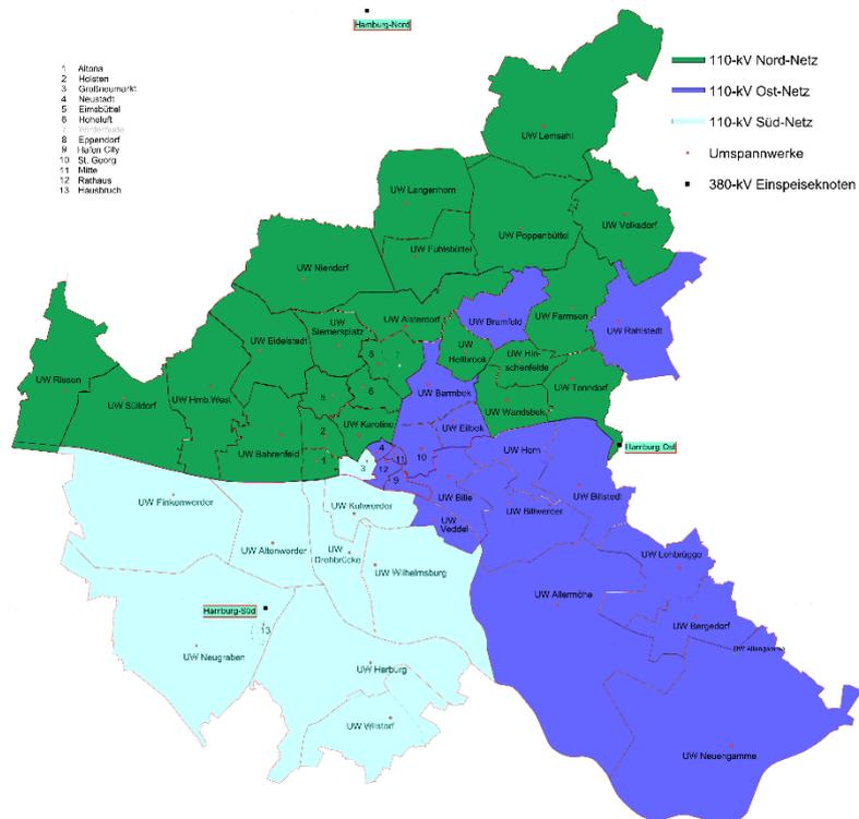
Abbildung 2: Versorgungsbereiche der HS/MS-Umspannwerke
